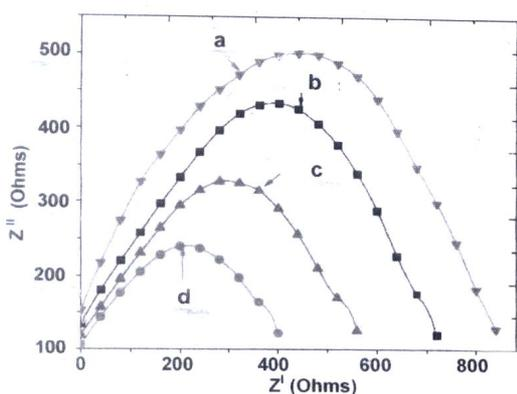
Fig.4 Nyquist plot of CdSe films deposited at different duty cycles (a) 6 % (b) 15 % (c) 33 % (d) 50 %
