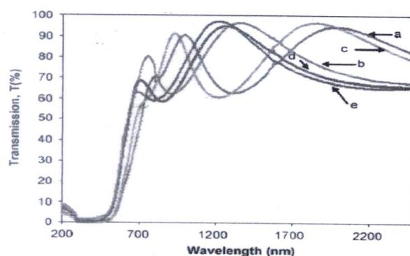
Fig.2 Transmission spectrum of CdSe films deposited at different duty cycles(a) 50 % (b) 33 % (c) 15 % (d) 10 % (e) 6 %
